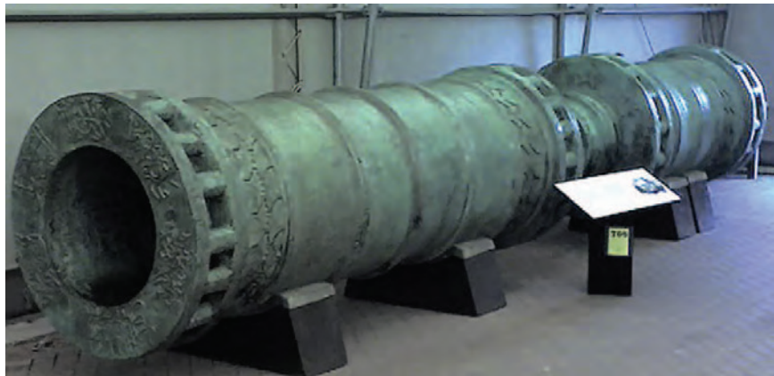
Basilica . Largo, 8 metros. Diámetro, 75 cm. Peso del cañón, 18 ton. Peso del proyectil, 544 kg. Alcance, 2 km.
