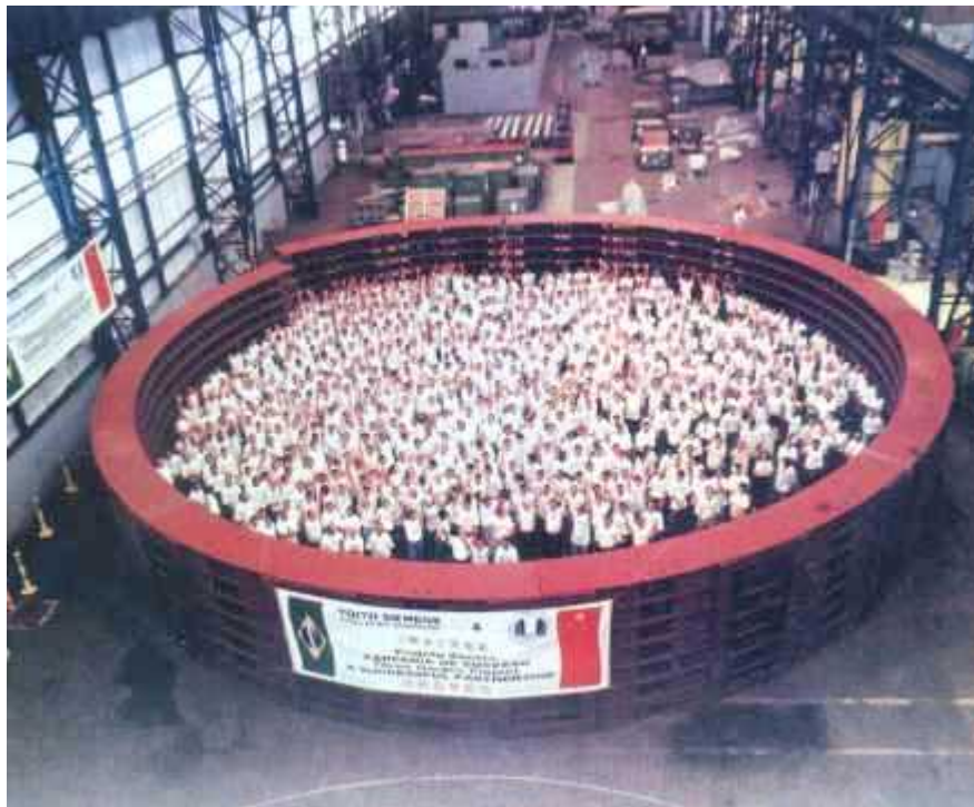
Foto Estator de 700 MW Voith Siemens Brasil
