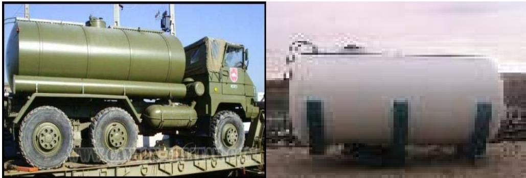
Vehículo cisterna y depósito de polietileno apto para el depósito de combustible y /o agua.
